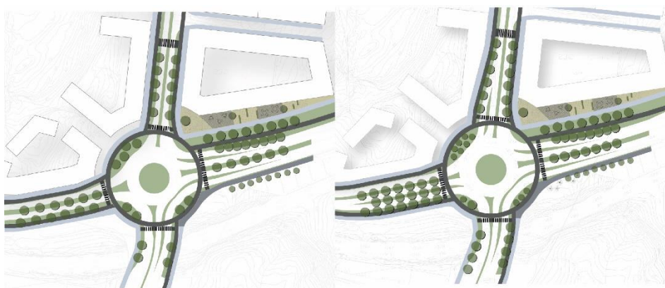
Figur 3. Torgyta på norra sidan av Hjalmar Brantingsgatan. Alternativ 1. Med svängfält på höger och alternativ 2. Utan svängfält på vänster.
