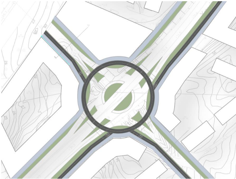
Figur 5. Principutformning - cirkulationsplats med genomgående busstrafik på Yrvädersgatan.
